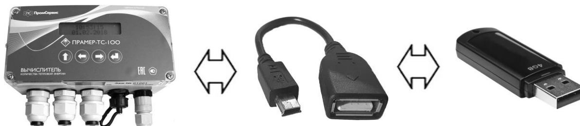
Рисунок 8 – Подключение USB Flash накопителя
